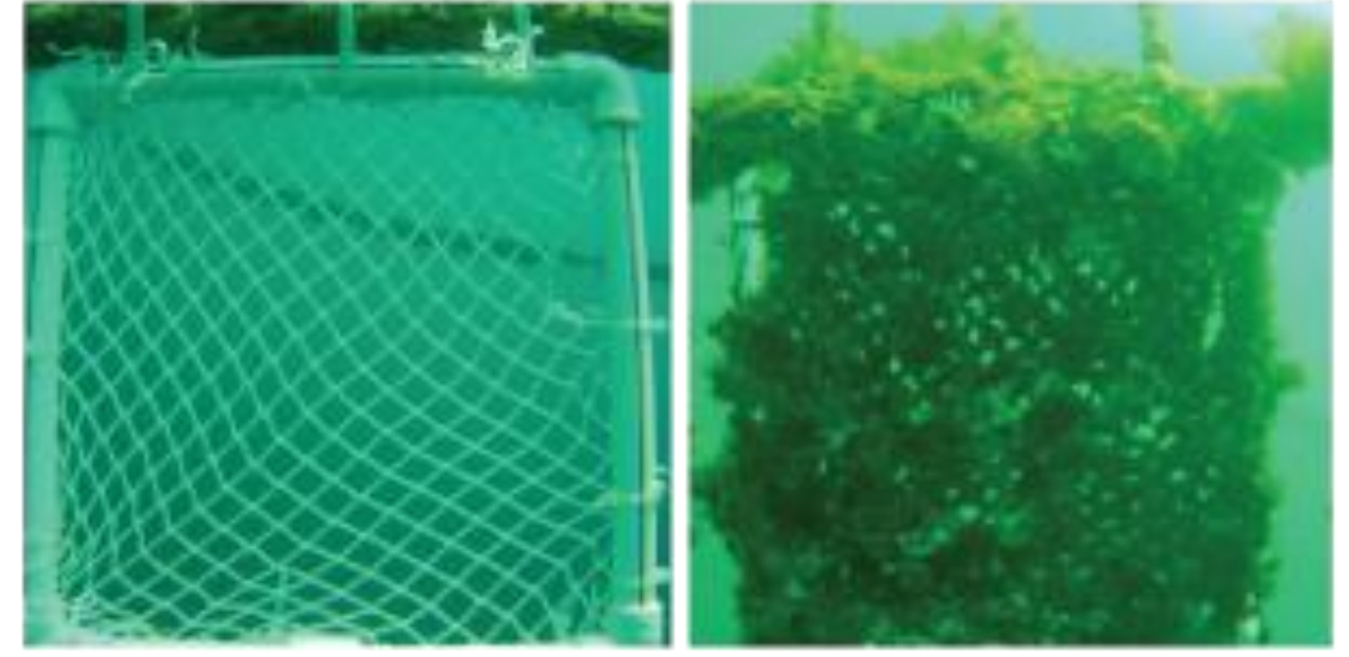
İşlem görmemiş balık ağının ilk ve 6 ay sonundaki denizaltı görüntüleri
