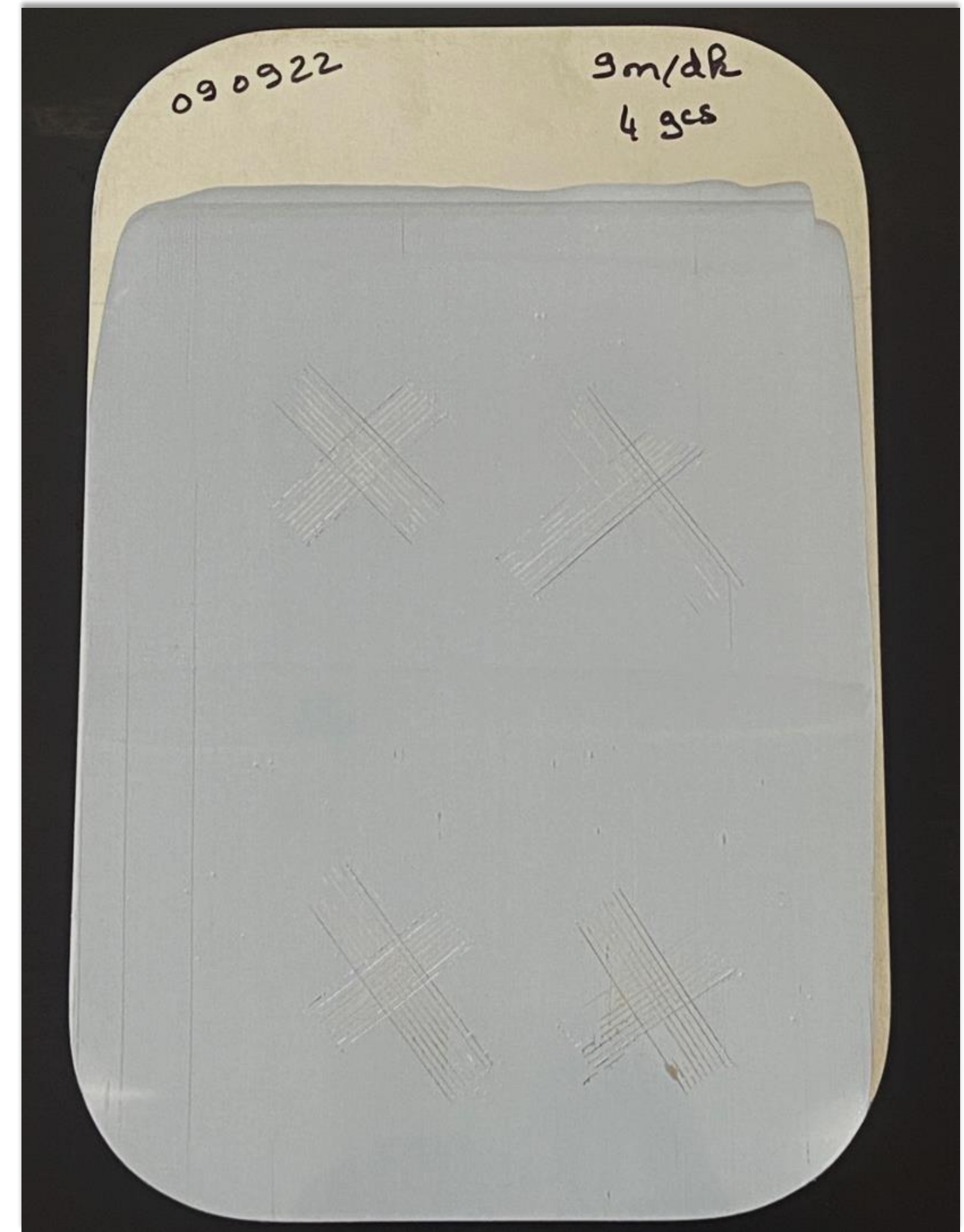
Metal Plaka Üzerinde Cross-Cut Adezyon Test Sonucu (ASTM- D-D3359) : 4B
