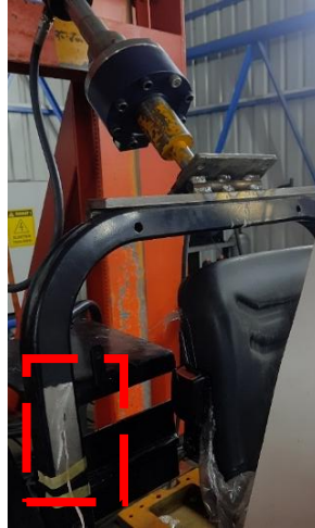
Sekil 5. StrainGauge Konumlandırılması
