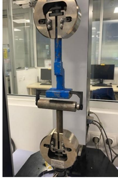
Şekil 1 Sap Çekme Testi (TS_EN_50342_5_4.4.4)
