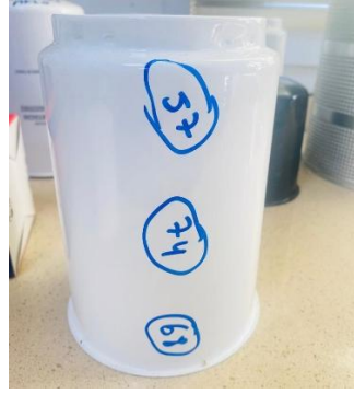
Şekil 13 Poliester Toz Boya ile Boyanan Metal kovan Mikron Oranları
