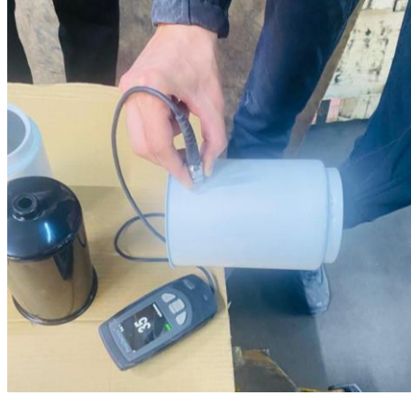
Şekil 14 Epoksi-Poliester Toz Boya ile Boyanan Metal Kovan Mikron Oranları
