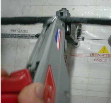
Resim 6 : Klips kelepçesi kesim işlemi
