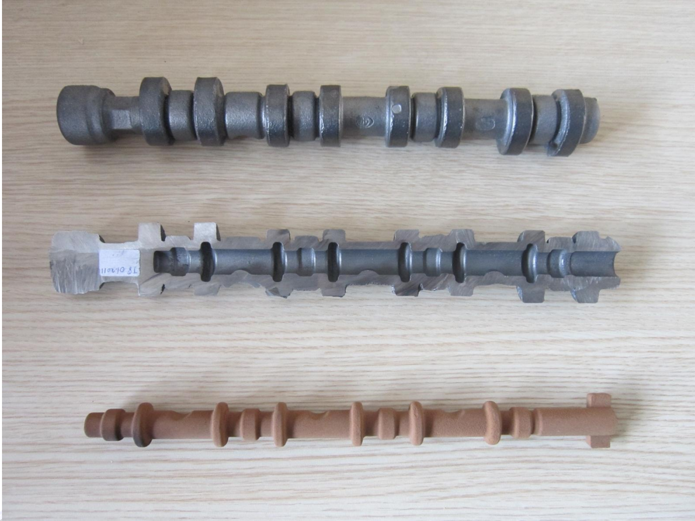
Yapılan Çalışmalarda Shell Maça Yöntemiyle Üretilmiş Mil
