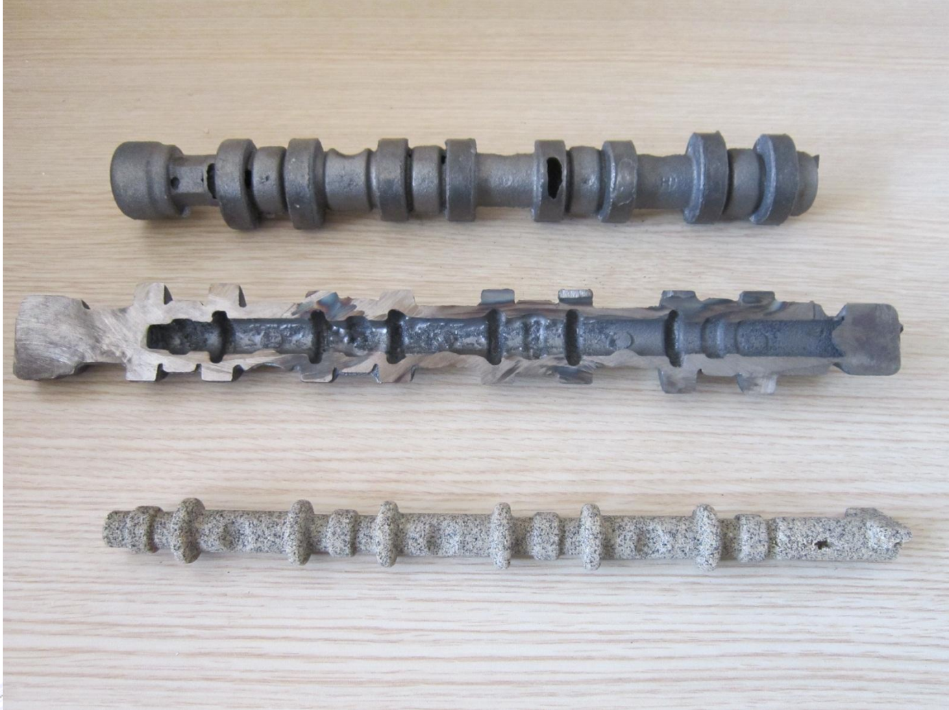
Yapılan Çalışmalarda Cold Box Maça Yöntemiyle Üretilmiş Mil
