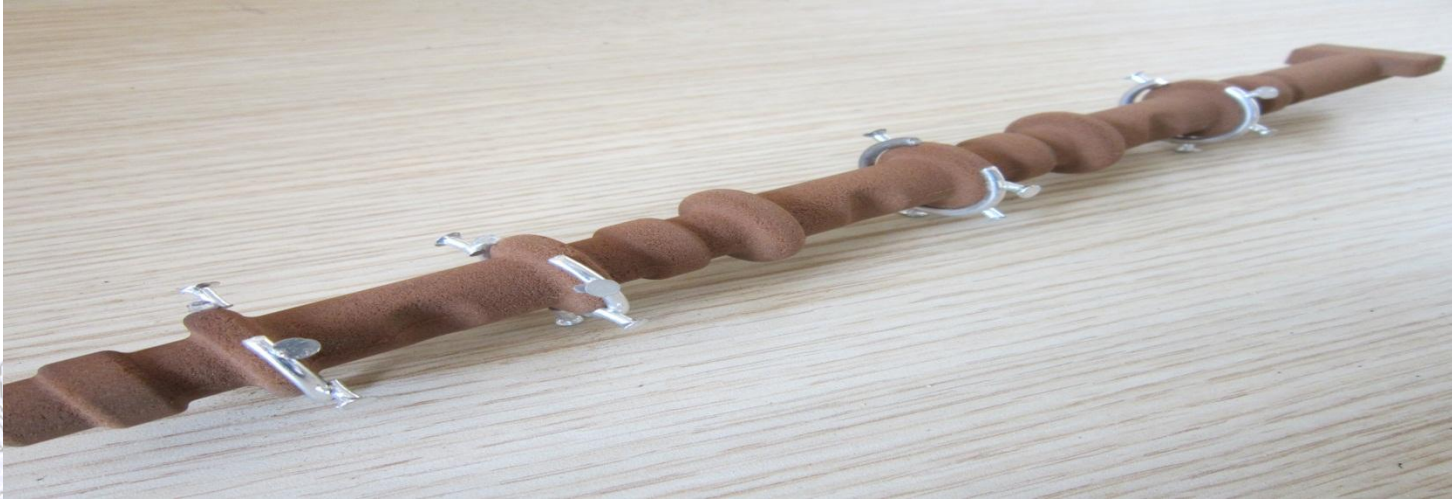
Kalıba Yerleştirilmeye Hazır Supportları Takılmış Maa
