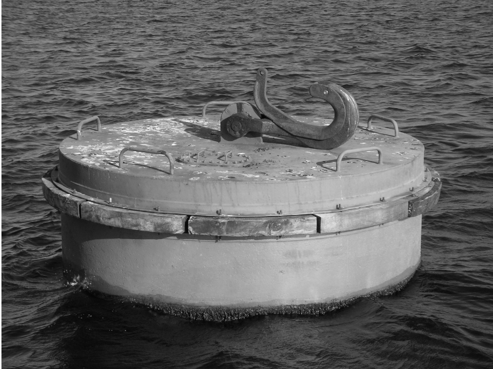
Şekil 3. Çok Noktalı Gemi Bağlama Sistemi için kullanılan şamandıra
